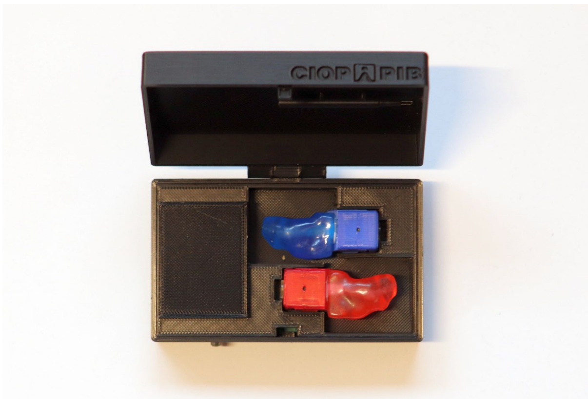
Fot. 1. Stacja dokująca (fot. Archiwum CIOP-PIB)
